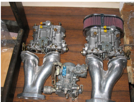
Slika prikazuje motor po fazi: popolnoma spremenjena uplinjača in sesalni kanali pred vgradnjo.
